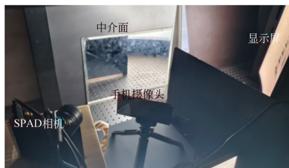
图6 被动NLOS成像实验场景
